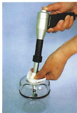
b. 連接所附之轉接器於手機上，再插入Turboclean並啟動使液體穿過手機。
